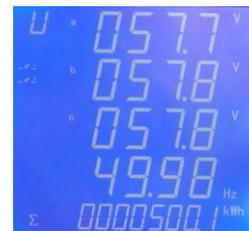
显示二次侧线电压  $U_{ab}$ ,  $U_{bc}$ ,  $U_{ca}$  和频率。
