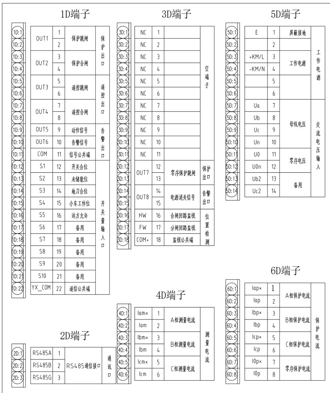
说明: 装置选为 B 型(变压器保护)时, 出口 OUT2:1D3-1D4 为非电量(超高温/重瓦斯跳闸)出口, 开关量输入 S6~S10 定义备用, 用户可根据需要自行配置。
