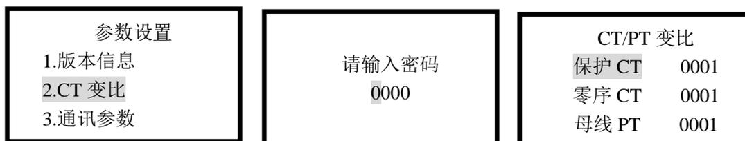
从主菜单进入到参数菜单后, 液晶屏首先显示请输入密码(密码初始值为 0000, 密码可在参数菜单里修改), 按“↑”或“↓”进行对光标所在位置的加减, 按“←”或“→”则是移动光标的位置, 输入正确密码后, 请按“确认”进入下一级菜单。注: 参数修改菜单密码: 1000。
